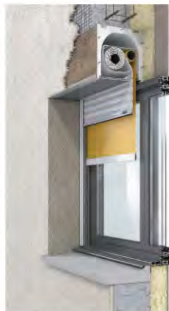
VOLET ROULANT TRADITIONNEL MONTÉ DANS COFFRE AVEC STORE OCCULTANT
